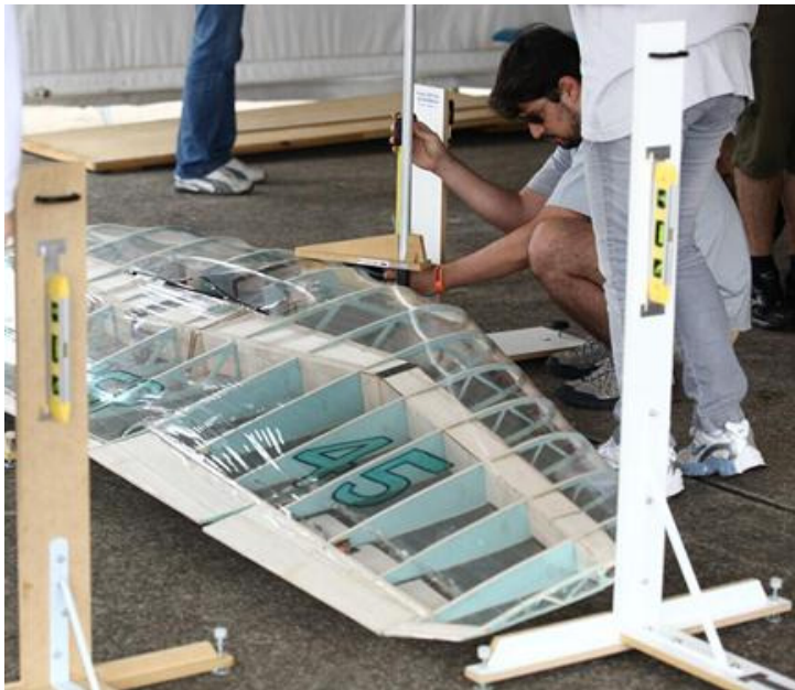
Medida de altura de uma aeronave que não possui empenagem vertical (asa voadora da Poli USP 2010)
