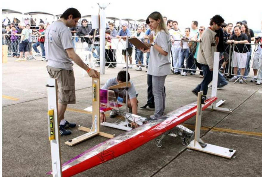
Medida de altura de uma aeronave com configuração convencional onde o ponto mais alto é a empenagem vertical (Equipe Tucano 2010). Observem o medidor de altura sendo posicionado.
