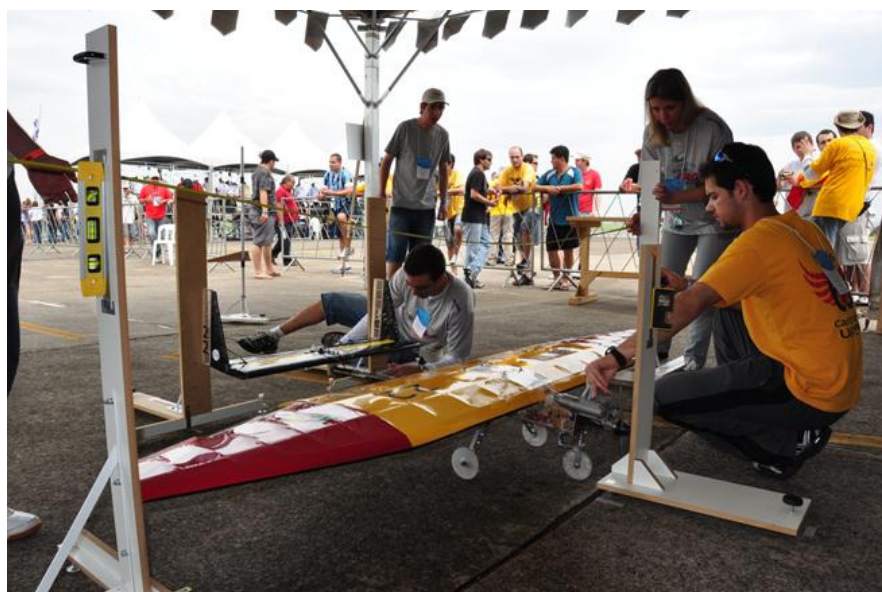
Medida de envergadura e comprimento de uma aeronave com duas caudas (Equipe Carancho 2010). Observem que os dois esquadros estão posicionados na parte mais traseira da aeronave (o bordo de fuga dos lemes).
